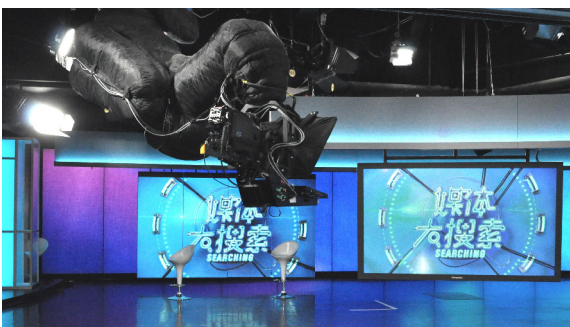
Das Roboter-Kamerasystem in Kombination mit einer Linearschiene ermöglicht große Freiheiten bei der Perspektivenwahl.
